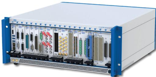
Le nouveau châssis PXIe 42-927 de Pickering Interfaces dispose d'un fond de panier PXIe hautes performances à 21 emplacements et accepte des modules PXIe (PXI Express) ou compatibles hybrides PXI standard dans tous les emplacements de périphériques. Le châssis Gen2 offre une bande passante de données élevée, avec un système
