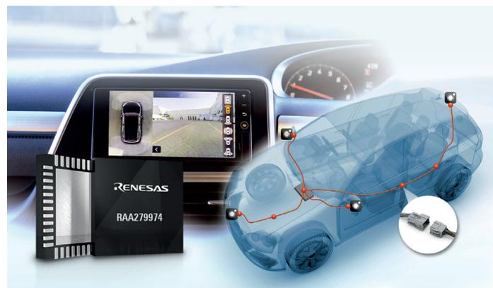
Le système AHL est robuste contre le bruit et offre une excellente qualité d'image. En raison de la nature fondamentale d'un signal analogique, une transmission vidéo AHL est supérieure contre le bruit et les interférences. Alors qu'une liaison numérique entraînera une perte d'image dans n'importe quelle condition bruitée, le système AHL conservera une bonne image en temps réel dans cet environnement, offrant ainsi une solution avec une sécurité accrue.
